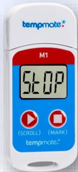
Para detener la trazabilidad y registro de temperatura del termógrafo, **debe mantener presionado 5 segundos el botón derecho (MARK)**.
