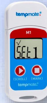
Se recomienda registrar marcas, las cuales serán visibles en el gráfico final con líneas verdes. **Para ello debe presionar el botón derecho (MARK)**, y en la pantalla LCD podrá visualizar "SET 1", para continuar con el registro de temperatura presione una vez el botón izquierdo (SCROLL).
