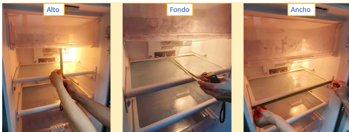
IMAGEN N°2. MEDIDAS DEL REFRIGERADOR QUE SE CONSIDERAN PARA EL CÁLCULO DE ALMACENAMIENTO
