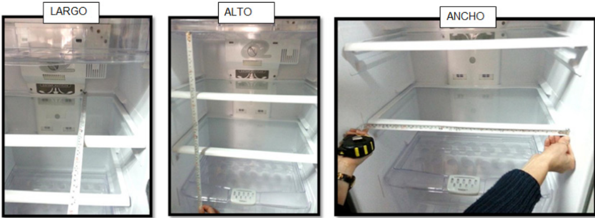
FIGURA N°4: MEDIDAS DE ALMACENAMIENTO EN REFRIGERADOR
